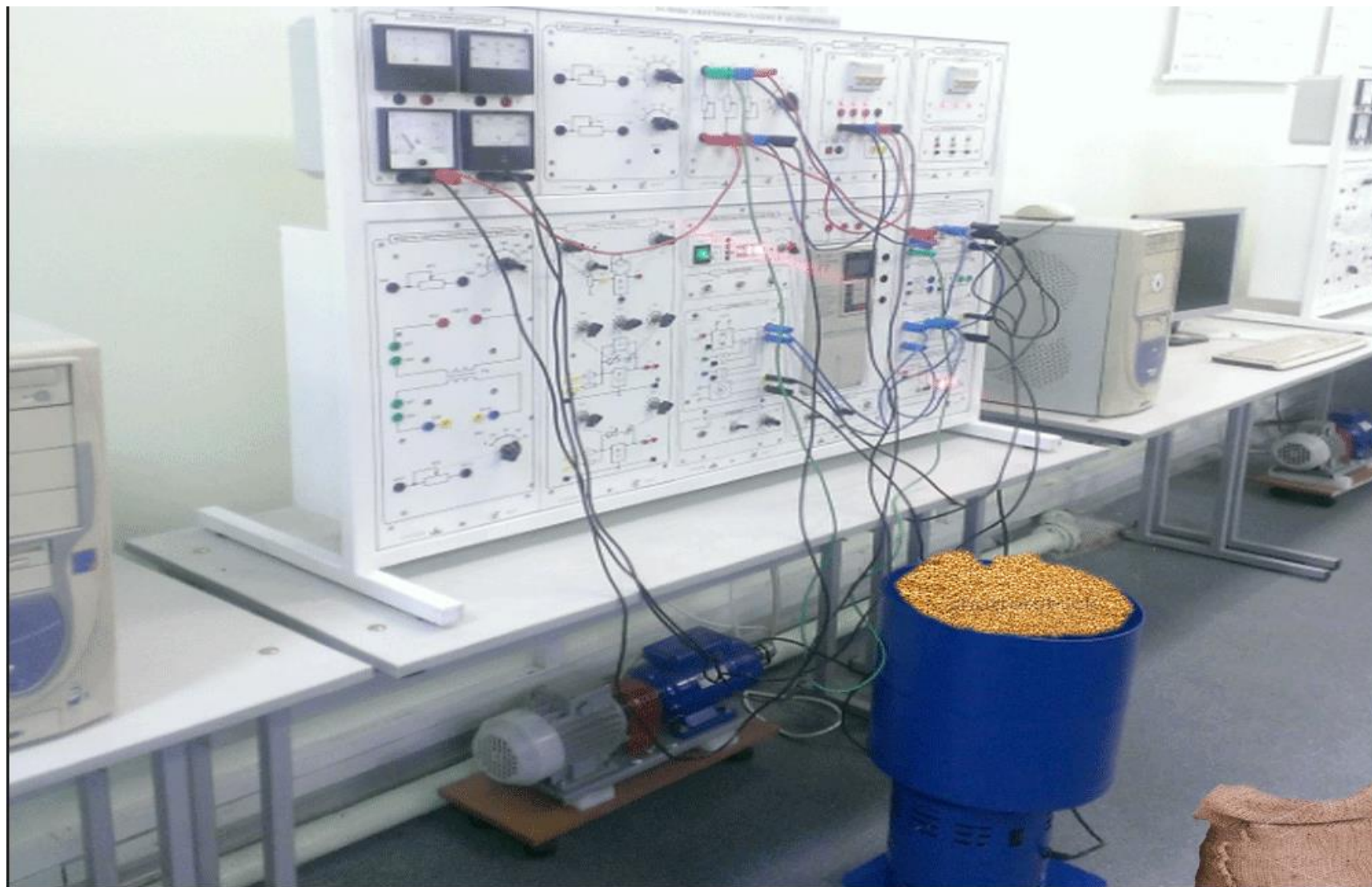
Рисунок 3.4 – Общий вид лабораторного стенда для исследования системы регулирования нагрузки
