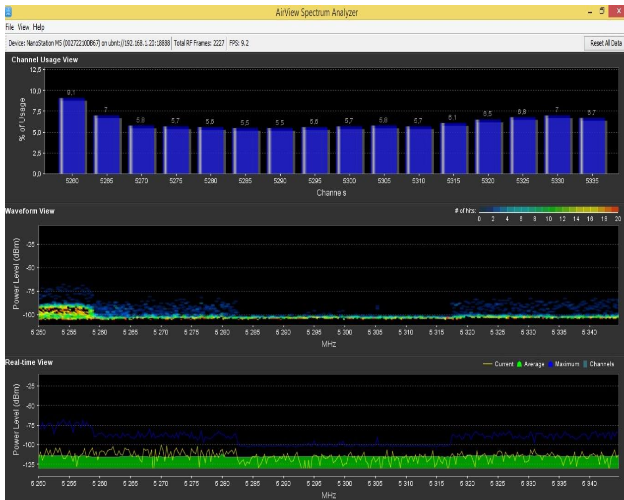
Рисунок Б.5 – Окно программы AirView Spectrum Analyzer: сканирование частотного диапазона 5 ГГц ( 1 – Диаграмма использования канала в % - Channel Usage View; 2 – График Waveform View; 3 – График Real-time View)
