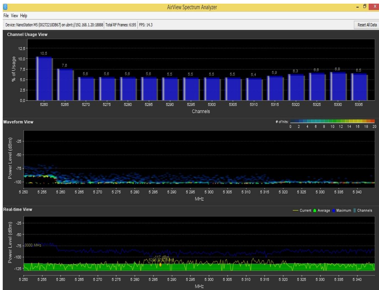
Рисунок Б.4 – Окно программы AirView Spectrum Analyzer: сканирование частотного диапазона 5 ГГц ( 1 – Диаграмма использования канала в % - Channel Usage View; 2 – График Waveform View; 3 – График Real-time View)
