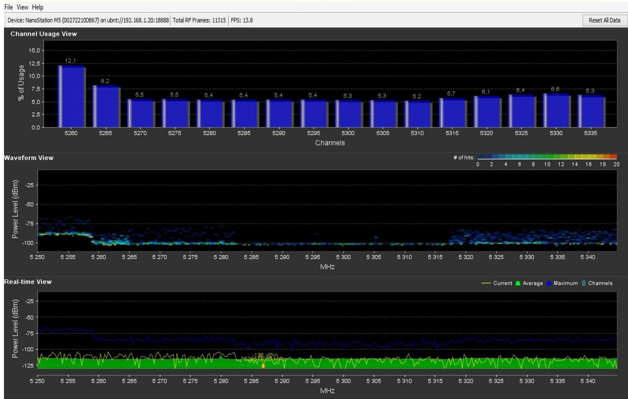
Рисунок Б.7 – Окно программы AirView Spectrum Analyzer: сканирование частотного диапазона 5 ГГц ( 1 – Диаграмма использования канала в % - Channel Usage View; 2 – График Waveform View; 3 – График Real-time View)
