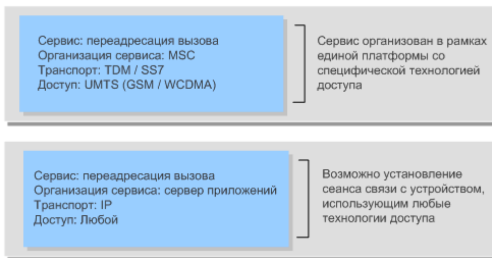
Рисунок 1.2 – Многоуровневый подход, используемый при построении IMS2
