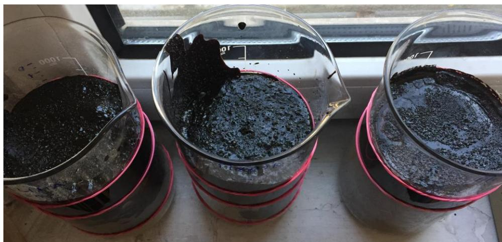
Рисунок 4.3.5 – Застывание нефти в пробах грунта
