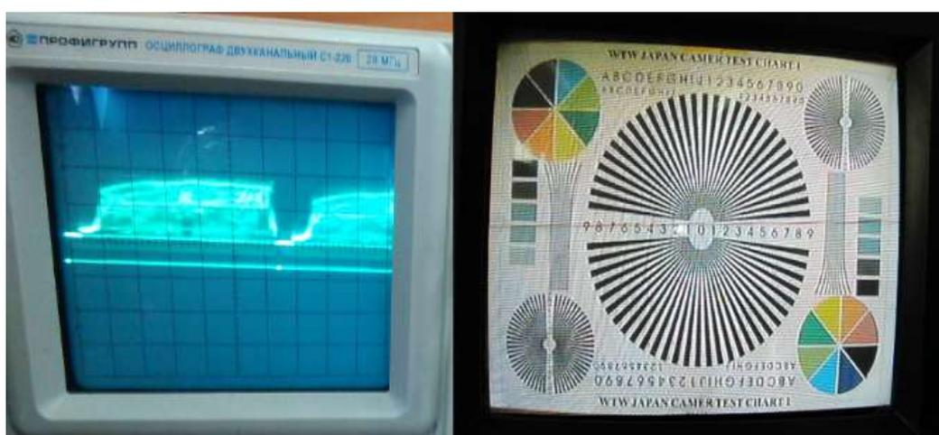
Рисунок 6.18 – Совместное применение визуального (справа) и инструментального (слева) методов контроля для тестовой таблицы, полученной с видеомонитора при использовании цветной видеокамеры ТАТ-603S, 380 ТВЛ при при освещении RGB светодиодами
