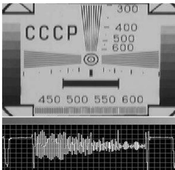
Рисунок 3.3 - Иллюстрация изображения муаров вертикального клина тест - таблицы, наблюдаемой телевизионной камерой на матрице ПЗС.
