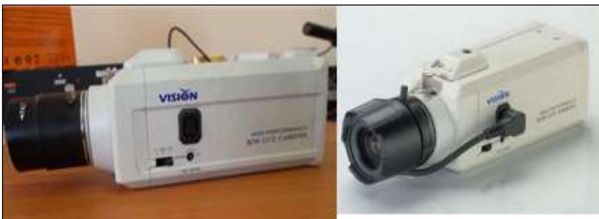
Рисунок 6.13 – Внешний вид VHT VC45B-230 модели видеокамеры
