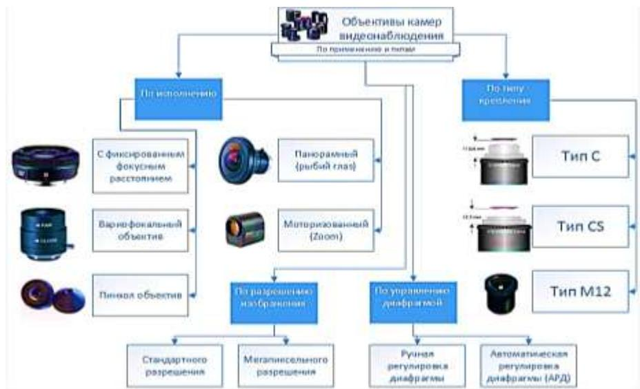
Рисунок 1.3 – Классификация объектива видеокамеры
