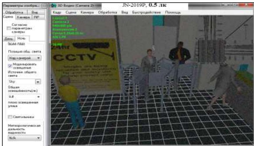
Рисунок 5.9 – Определение чувствительности (минимальной освещенности) цветной видеокамеры JN-2019P с разрешающей способностью 420 ТВЛ
