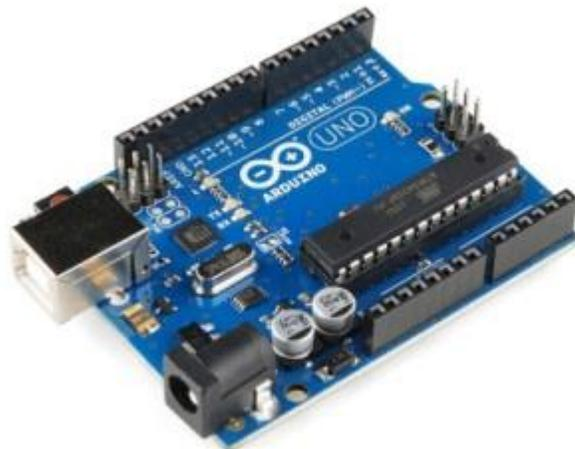
Рисунок 3.2.1.1 - ArduinoUno R3 Board
