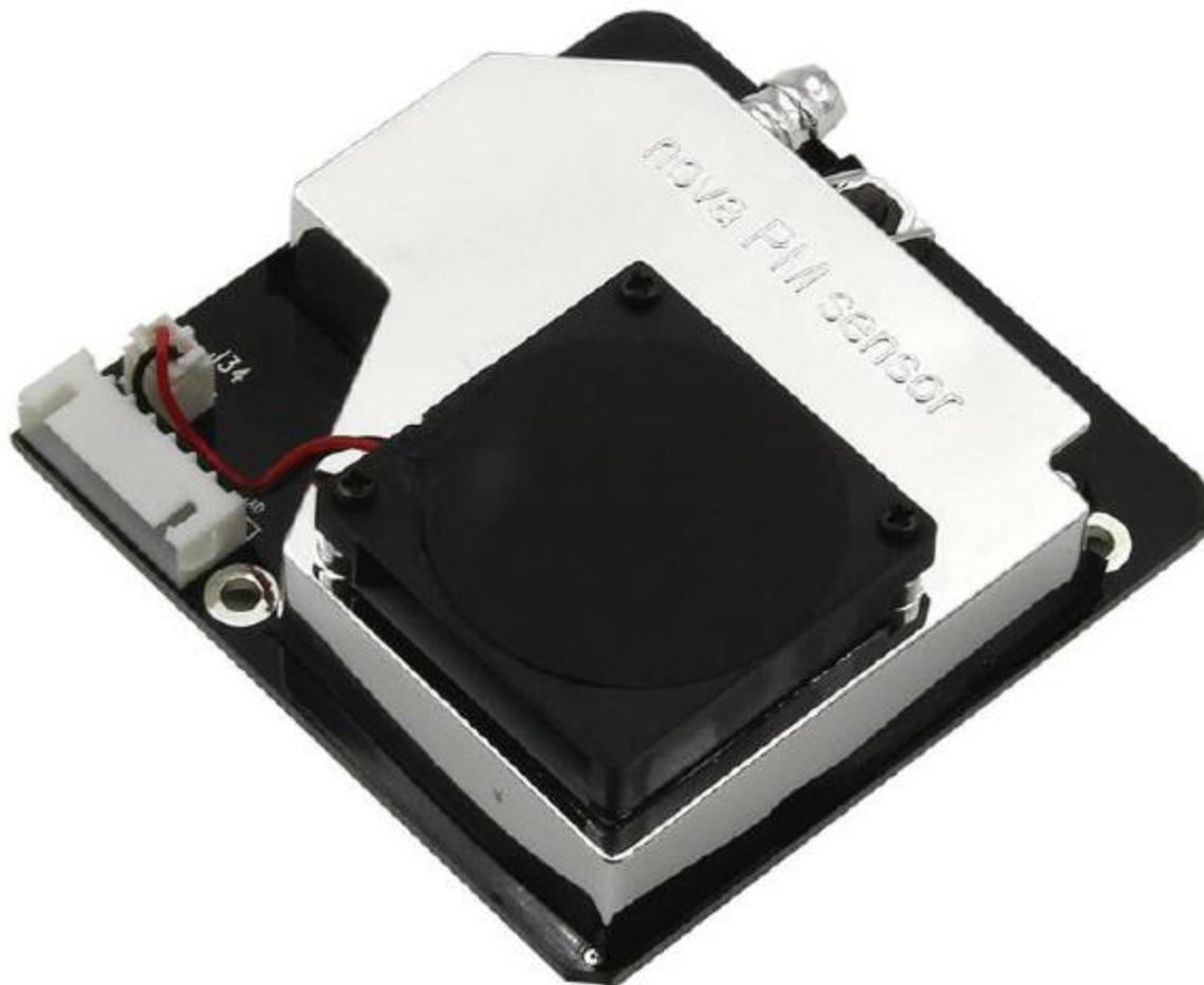
Рисунок 3.2.4.1 - Лазерный датчик пыли(SDS011)
