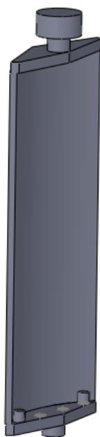
Рисунок 3.14 – лопасть ветрогенератора
