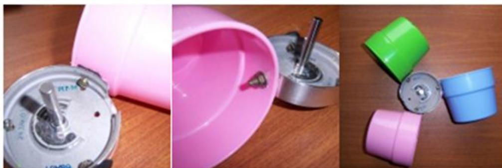
Рисунок 3.11 – Вращательная часть анемометра
