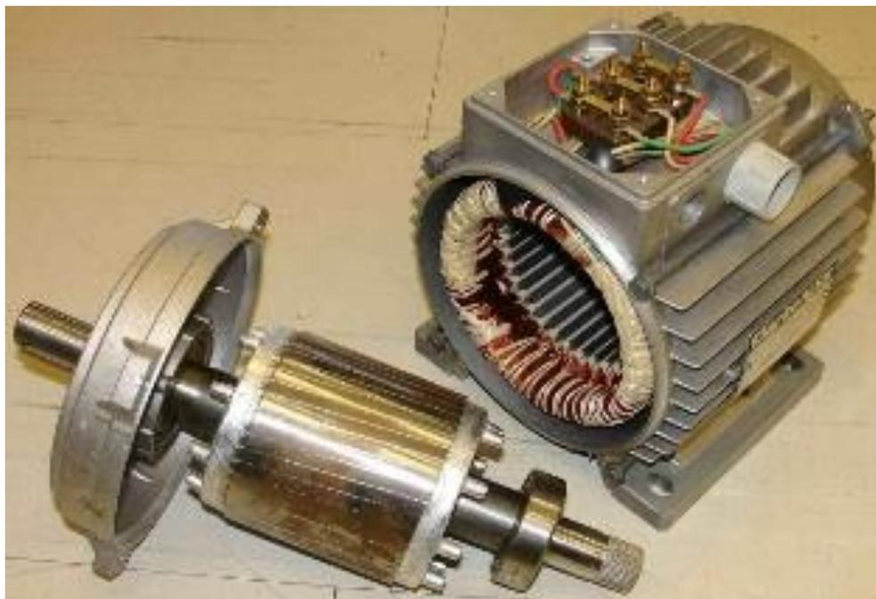
Рисунок 2.2 – Асинхронный двигатель
