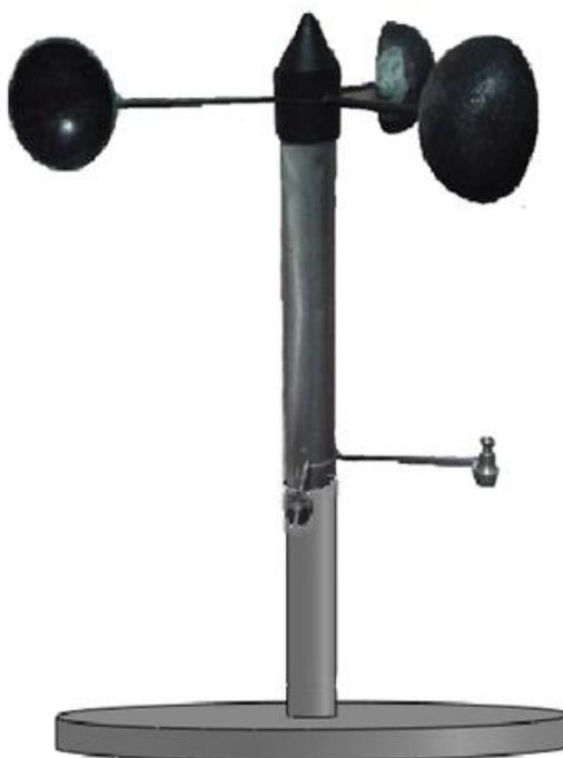
Рисунок 3.12 – Механическая часть анемометра
