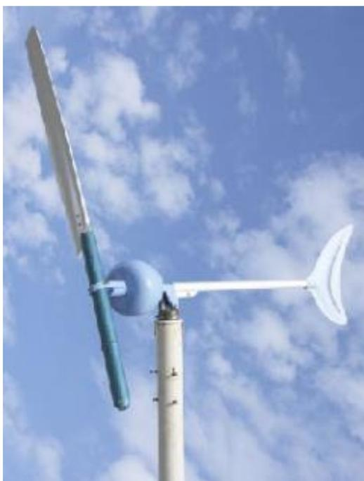
Рисунок 1.17 – Однолопастной ветрогенератор
