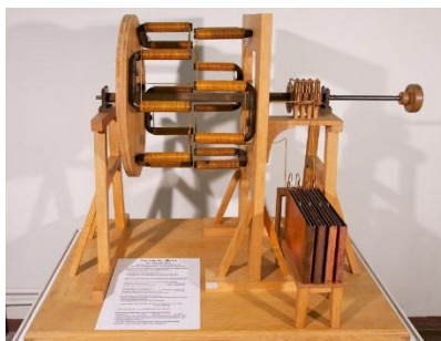
Рисунок 1.6 – Электродвигатель Морица фон Якоби
