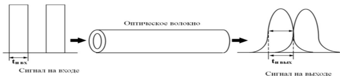
Рисунок 2.4 – Искажение формы импульсов вследствие дисперсии
