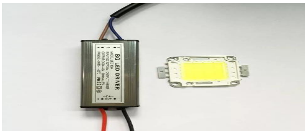
Рисунок 1.4 – Обзор светодиодного драйвера со светодиодным модулем
