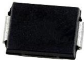
Рисунок 2.17 – Диод Шоттки SMD
