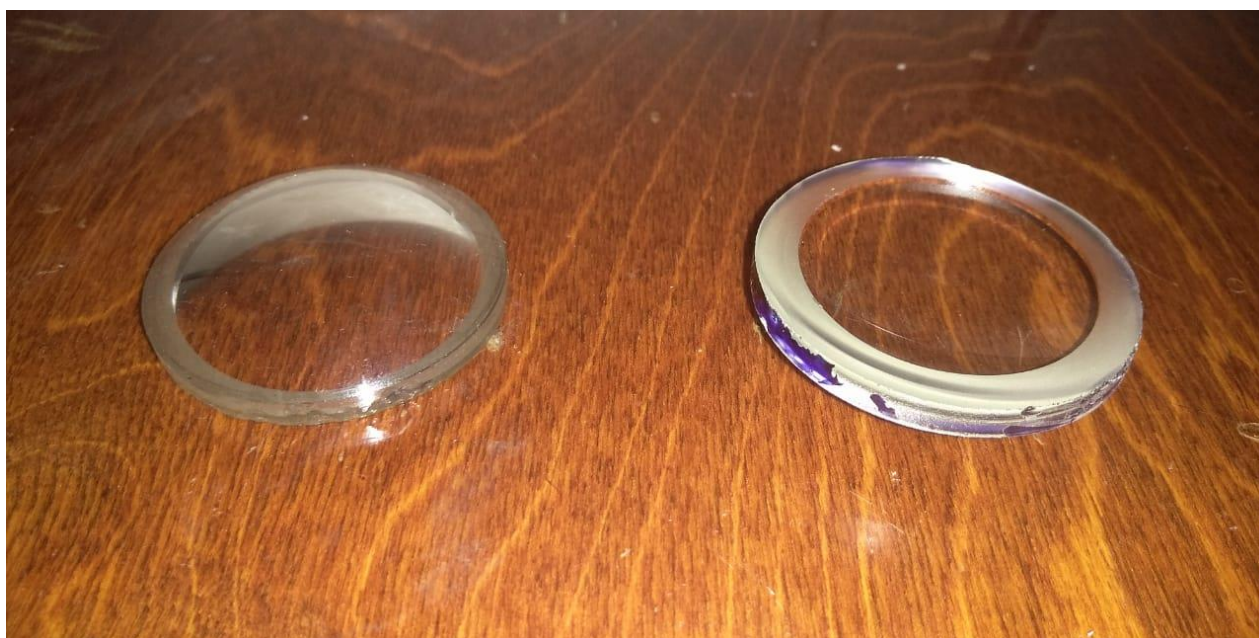
Рисунок 57 – Сапфировая стеклянная линза с нулевой диоптрией
