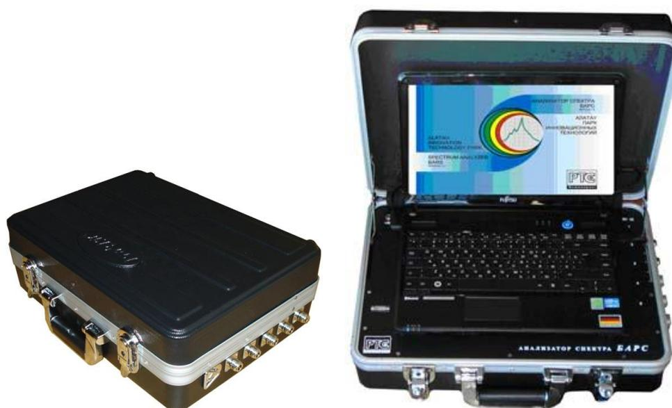
Рисунок 2.8 - Внешний вид многоканальный анализатор спектра «БАРС»
