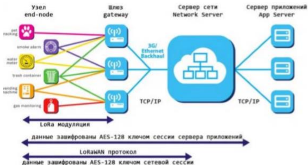
Рисунок 2.2 - Архитектура сети LoRa
