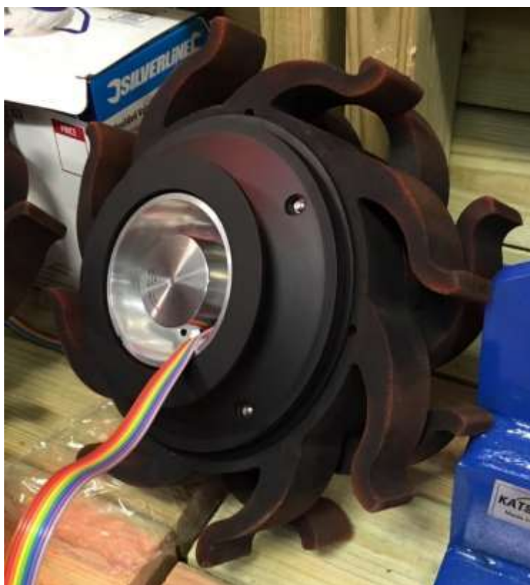
Рисунок 1.9 - Ступичный привод тахоп ЕС 45 во время сборки
