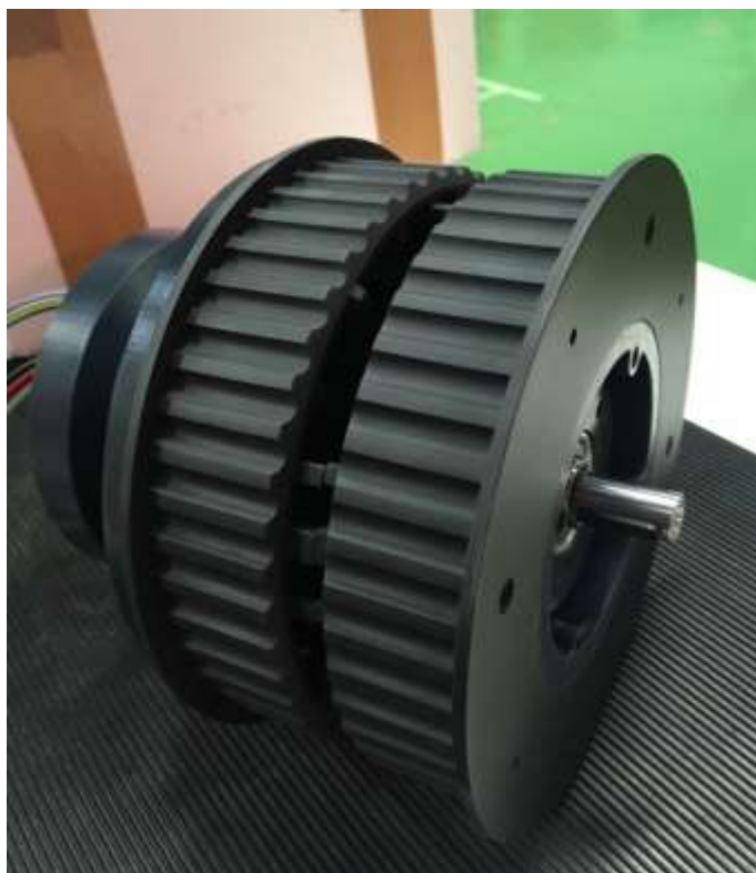
Рисунок 1.8 - ЕС60 Привод ступицы на 150 Вт во время сборки
