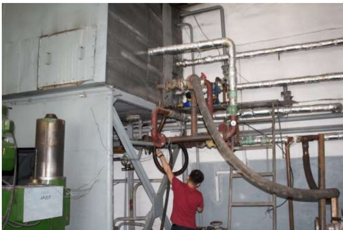
Рис 3.1 – Общий вид теплообменника ПВ 89*3-1-П-Z-У3 в период подготовки испытаний на специализированном стенде ТОО «Казкотлосервис»
